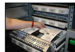
**NOTA:** Se pueden cargar varios paquetes de boletos usando la cinta perforada exclusiva de IGT para pegar el extremo final de un paquete al inicio de otro paquete.
